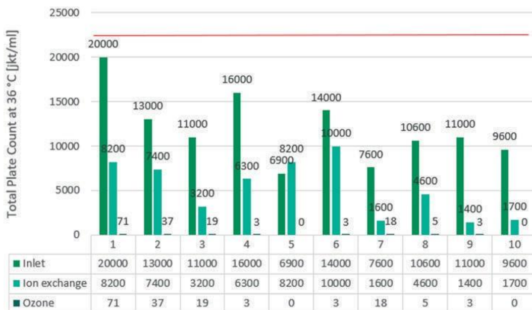
Rysunek 28. Wyniki eksperymentów przeprowadzonych odnośnie całkowitej liczby bakterii w temperaturze 36°C
