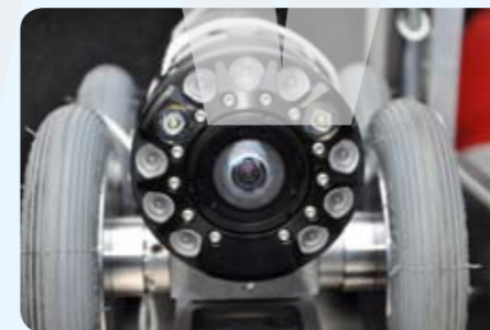
Kamera do badania wnętrza kanału fot. E.Marynowicz-Puchalska/MPWiK
